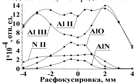
Рисунок 8. – Зависимость интенсивности линий Al II (466,3 нм), Al III (452,92 нм), N II и полос AlN и AlO в спектрах от расфокусировки
