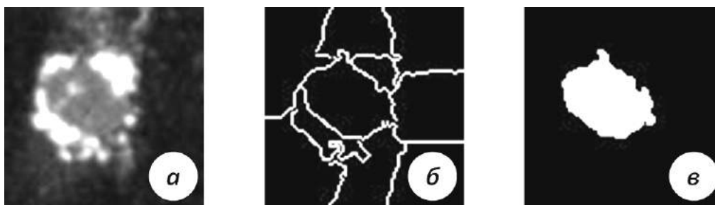
a – участок изображения; б – карта суперпикселей; в – ключевой суперпиксел Рисунок 6. – Схема выделения участка изображения и ключевого суперпикселя
