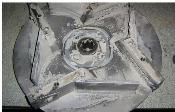
**Рисунок 15. – Разработанный ускоритель с отводящими элементами**
