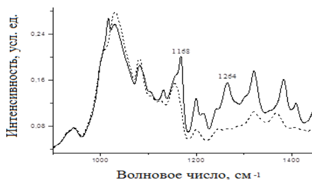
Рисунок 2. – Фурье-ИК спектр смеси HP- \beta -CD и кверцетина (сплошная линия) и комплекса включения кверцетин-HP- \beta -CD (прерывистая линия)
